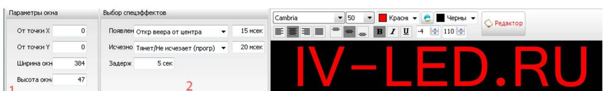
1 – Показывает размер поля под текст, а так же его координаты. Размер поля может совпадать с размером экрана, а может быть меньше. Это используется при необходимости создания двух и более независимых частей экрана.
